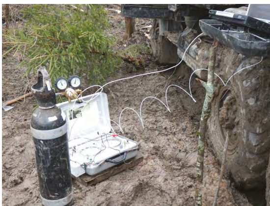
4 pav. Dilatometrijos bandymas, IAE teritorija, Visaginas 2012 m. (UAB „Geotestus“).
