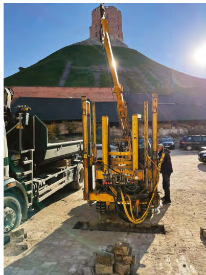
3 pav. Statinio zondavimo bandymas, Arsenalo g. 1, Vilnius, 2021 m. (UAB „Geotestus“).
