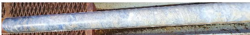
25 pav. Trijų metrų ilgio dekoratyvinio anhidrito (angelito) kernas iš gręžinio Pagirių telkinyje.
