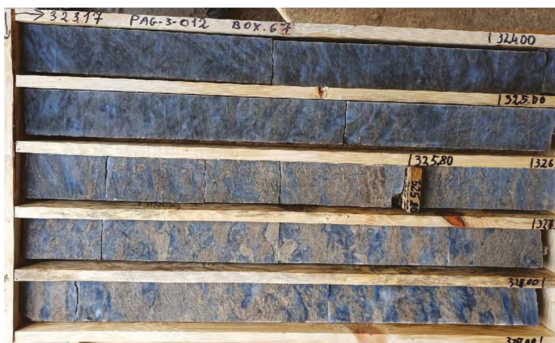
29 pav. Dėmėtojo anhidrito pluoštas iki 325,8 m gylio ir apatinio gipso-anhidrito pluoštas nuo 325,8 m gylio. PAG_3_012 gręžinys.
