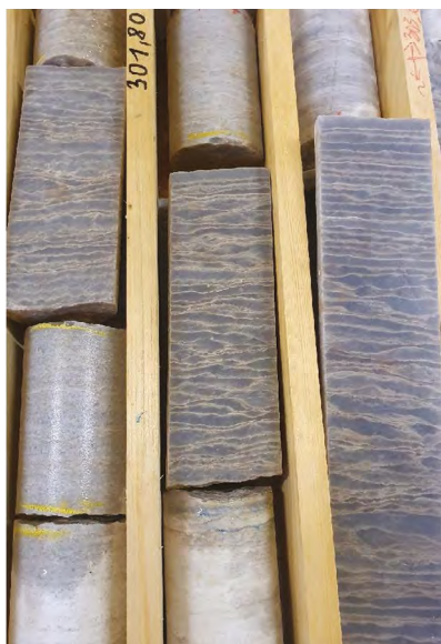
28 pav. Juostuotojo anhidrito pluoštas. PAG_3_014 gręžinys.
