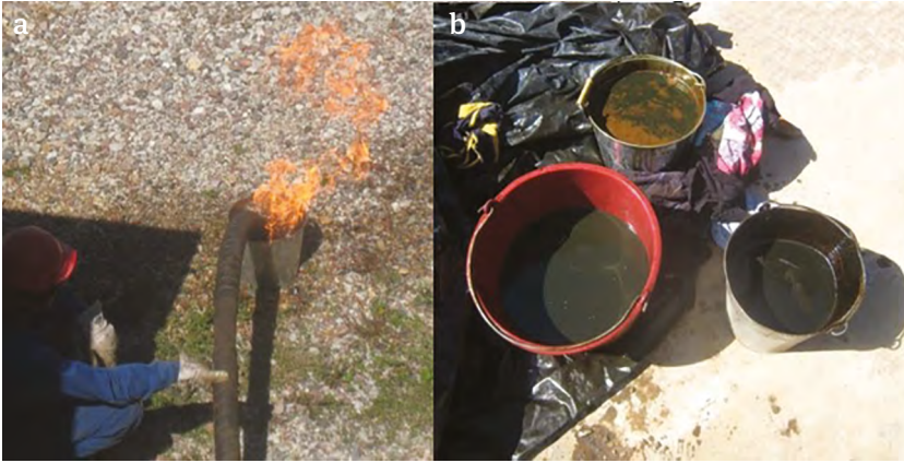
39 pav. Pocių-4 gręžinyje iš skalūnų išgautos dujos (a) ir nafta (b). (UAB „Minijos nafta“ duomenys). I. Vaičeliūno nuotr.
