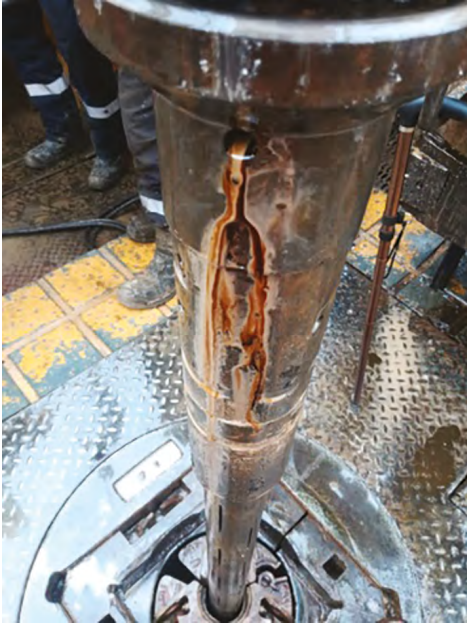
35 pav. Bandymų rezultatai Kudirkos-1 gręžinio 757,2–773,7 m intervale. Per 5 val. 15 min. gauta 9 l vandens ir naftos plėvelė (UAB „Diseta“ duomenys). I. Vaičieliūno nuotr.
